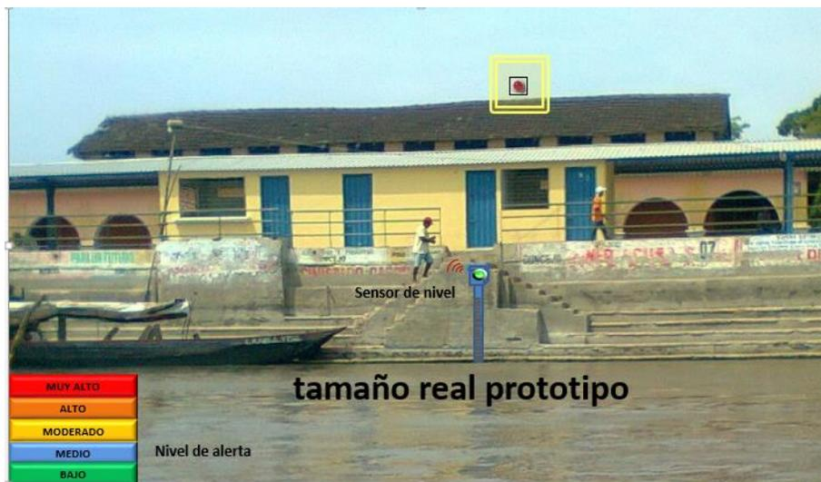
Figura 57. Sensor de nivel Max2 en campo.
