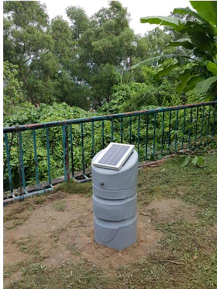
*Figura 42. Cubierta segura que aloja la guía de onda y el sensor, con un panel solar integrado
