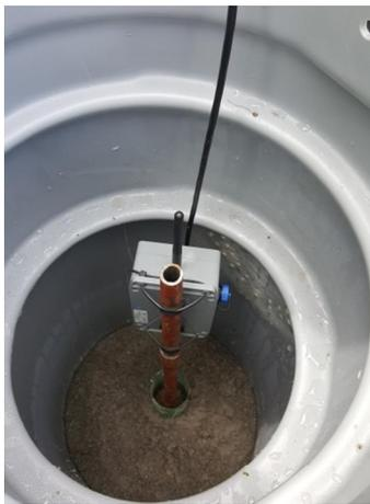
Figura 49. Sensor conectado a la guía de onda y protegido por la cubierta
