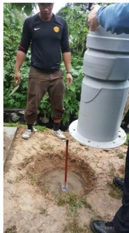
Figura 48. Puesta de a cubierta para encapsular y/o proteger la guía de onda
