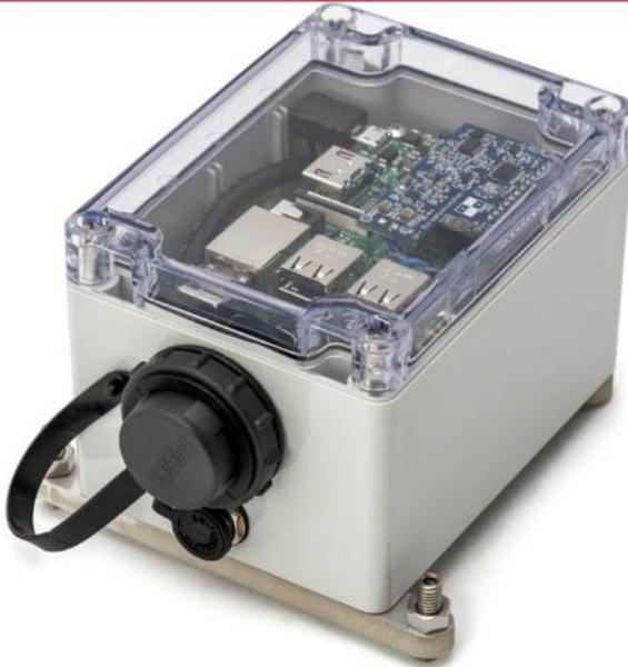
*Figura 61. Dispositivo de sensor para remoción en masa y avenidas torrenciales
