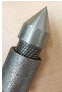
*Figura 44. Un cono atornillado en el extremo delantero del tubo de acero para facilitar la conducción de la guía de onda
