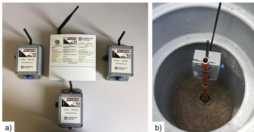
Figura 40. a) Componentes del sensor CSS y la estación base y b) una vista de un sensor ubicado en la guía de onda dentro de una cubierta.
